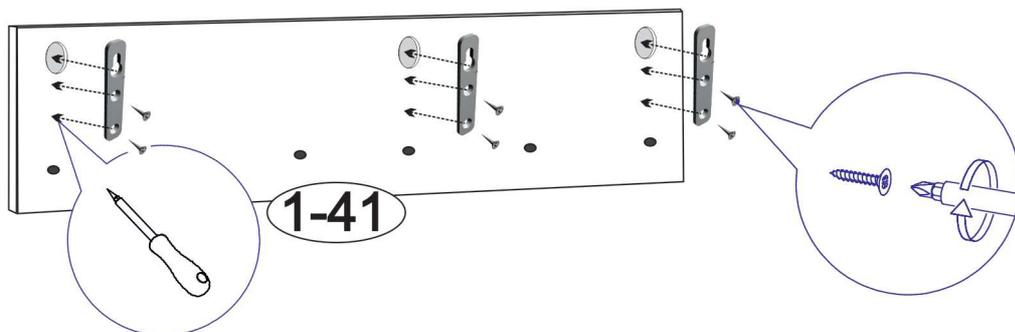
2. Соедините стенку заднюю (поз. 1-41) со стенкой горизонтальной (поз. 2-41) винтами-конфирматами (К-7а).
