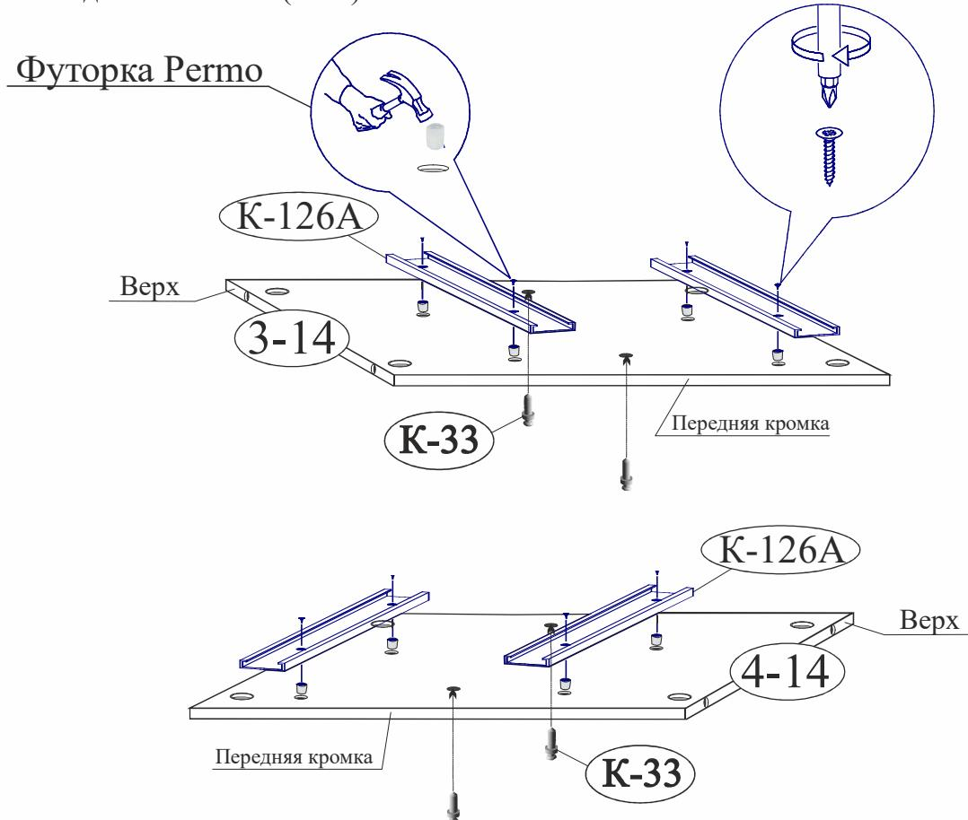
Крепление направляющей (К-126А) к перегородкам (поз.3-14, 4-14)
