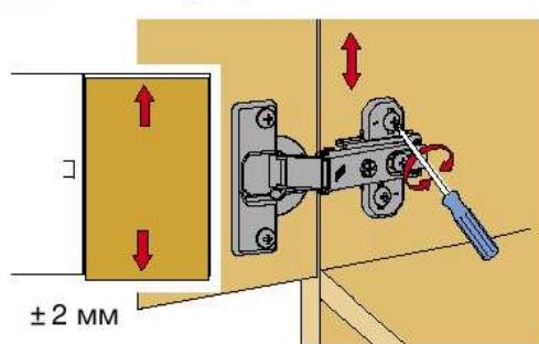
Слегка ослабить крепежные винты ответной планки, выверить по высоте позицию двери. Затем крепежные винты снова затянуть.
