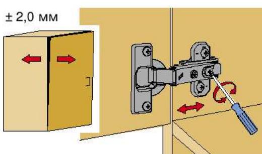
Ослабить крепежный винт и отрегулировать расстояние между дверью и боковой панелью шкафа. Затем снова затянуть крепежный винт.
