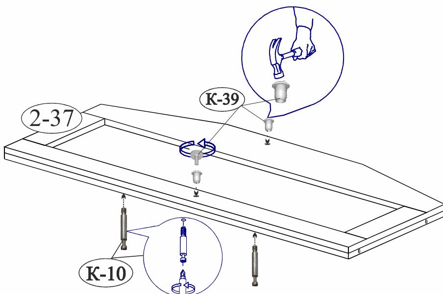
5. Закрепите к стенке горизонтальной (поз. 2-37) перегородки (поз. 3-14, 4-14) и стенки вертикальные (поз. 1-37) на стяжки (К-10).
