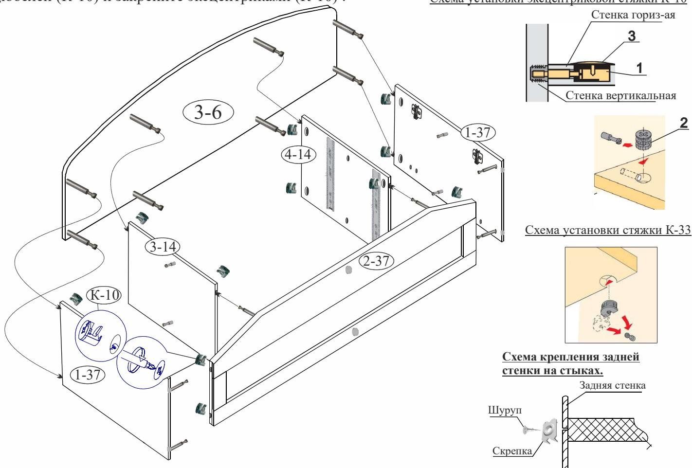
7. Установите на стенки горизонтальные (поз. 4-6, 10-6) стяжки (К-33) и закрепите на дюбелях (К-33). Выровняйте каркас(замерив проемы по диагонали), установите стенки задние (поз.5-37, 6-37) и закрепите к стенкам вертикальным шурупами с шайбами (К-45), к перегородкам скрепками (К-59) с градацией 150 мм. Между стенками задними (поз. 12-14) установите планку соединительную (К-24).
