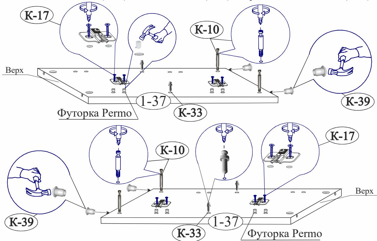
2. Закрепите на столешнице (поз. 3-6) дюбеля стяжки эксцентриковой (К-10).
