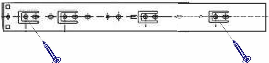
4. Закрепите дюбеля стяжки (К-10). Аккуратно забейте гайки для ножки (К-39) в несквозные отверстия Ø8 на стенку горизонтальную (поз. 2-37). Закрутите опору регулируемую (К-39).
