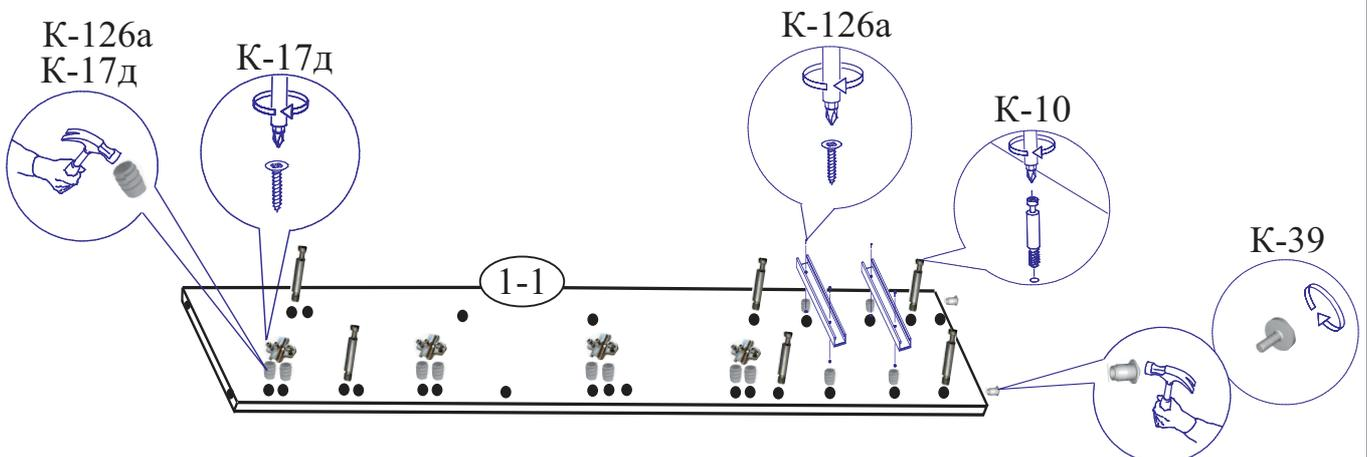
2. Осторожно забейте футорки (К-17д, К-126а) в отверстия на детали (2-1), установите планку петли и широкую часть направляющих (К-126а).
