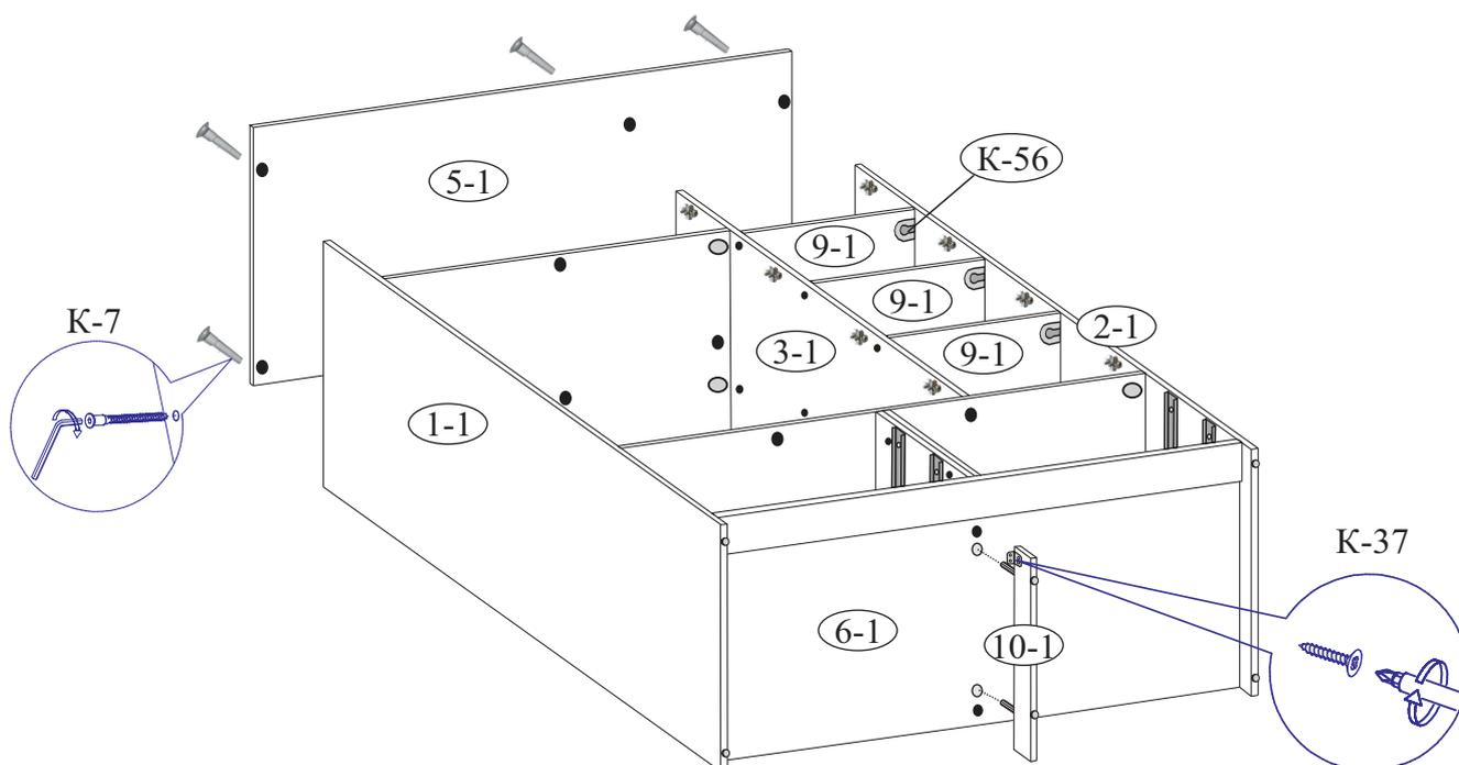
\*Перед закручиванием шурупов необходимо наколоть дополнительные отверстия шилом.
