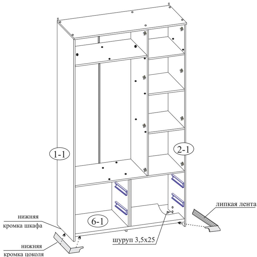
10. Установите шкаф в нужное место, отрегулируйте ножки (К-39) и закрепите шкаф к стене, см. примечание лист 3.
