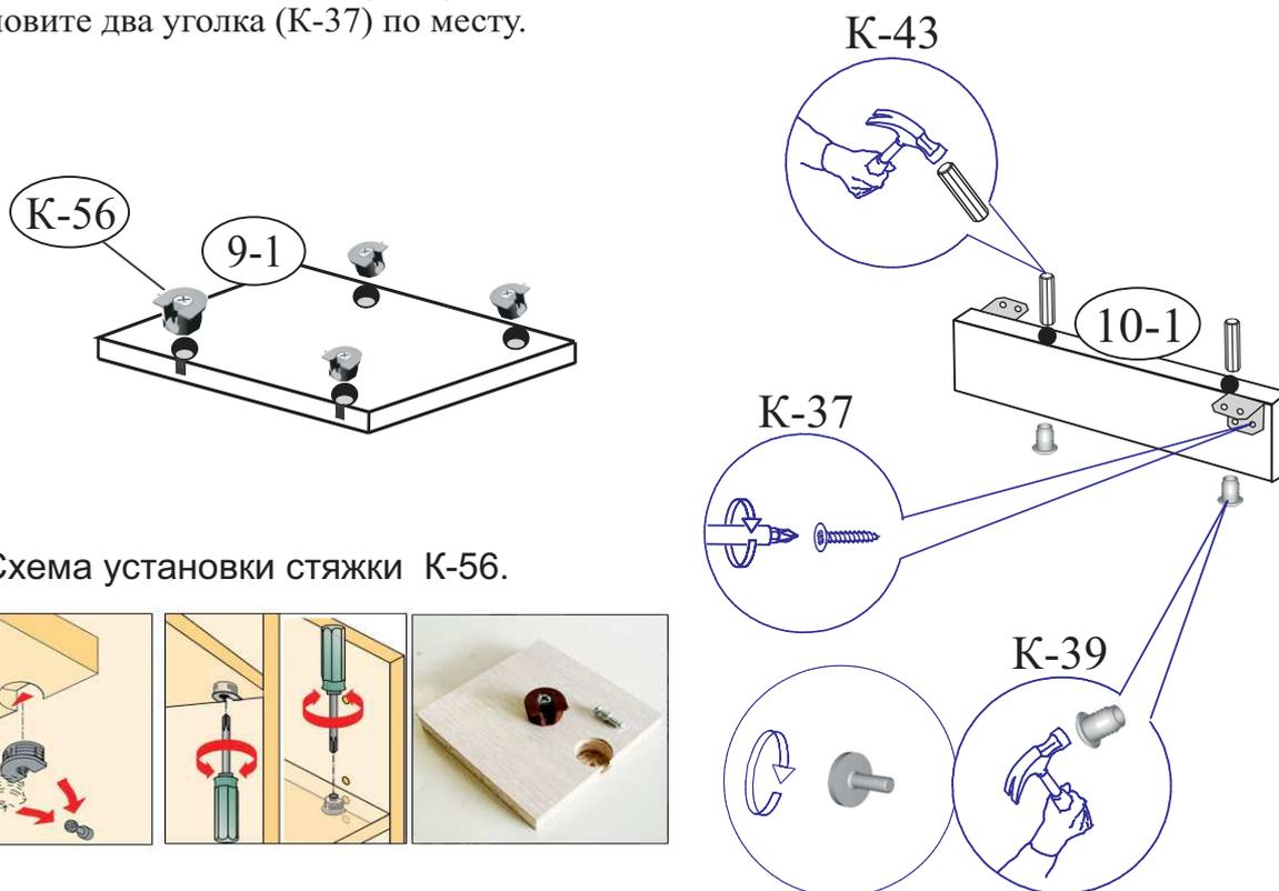
Схема установки стяжки К-56.
