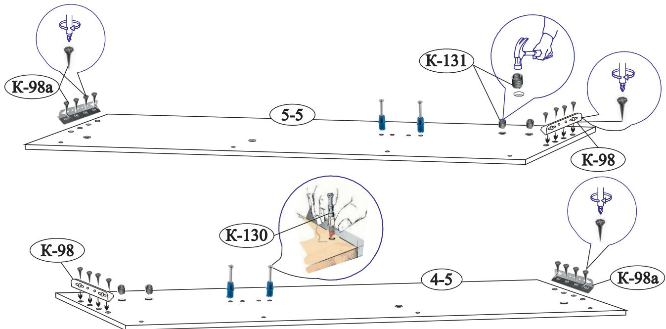
2. Установите дюбеля стяжки (K-130) в отверстия на накладке декоративной (поз. 2-5).
